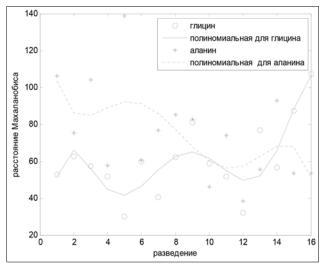
*Рис. 2.* Графики и их полиномиальная аппроксимация изменения расстояния Махаланобиса водных систем при разведении 1N раствора глицина и аланина.
